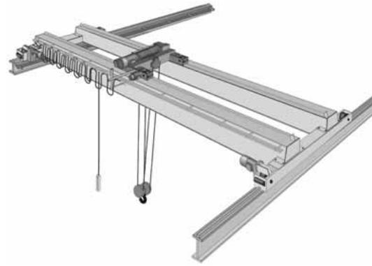
Os mecanismos de transporte de cargas mais utilizados na indústria são as pontes rolantes e os pórticos rolantes. Eles permitem grande flexibilidade no deslocamento das cargas. A figura acima mostra um desenho esquemático de uma ponte rolante.
