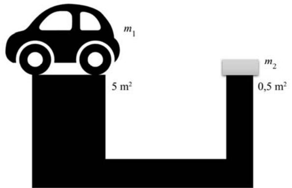
Tendo como referência essa representação de uma prensa hidráulica, na qual  $m_1 = 2.000 \text{ kg}$  é a massa do veículo e  $m_2$  corresponde à massa do sólido presente na extremidade oposta ao veículo, julgue o próximo item, de acordo com o princípio de Pascal, e considerando a aceleração da gravidade como igual a  $10 \text{ m/s}^2$ .
